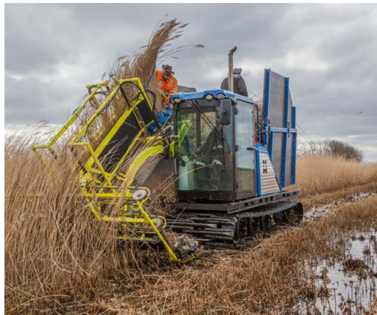
Abb. 4.5 Raupenbasierter Vollernter des Herstellers Hanze Wetlands BV für die Dachschilfernte
